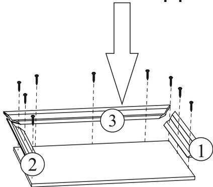
Карниз рекомендуется крепить в последнюю очередь, с помощью шурупов 4x25. Строго соблюдая угол 45 градусов между элементами карниза
